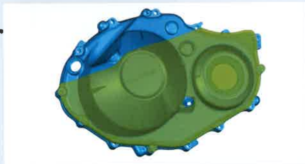
› Slika 4: Izdelava zaščitnega pokrova za ohišje menjalnika za motocikel Honda; zelo pomembno je bilo natančno prileganje na ohišje, zaradi česar smo slednjega skenirali in ga uporabili kot osnovo za vzratno inženirstvo
