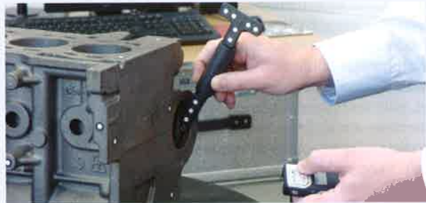
› Slika 6: Merjenje s tipalom za uporabo z ATOS sistemi (vir: scanare3d.com)
