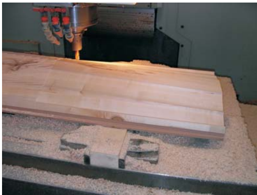
Slika 8: Izdelava lesenega pramodela v orodjarni EMO-TECH
